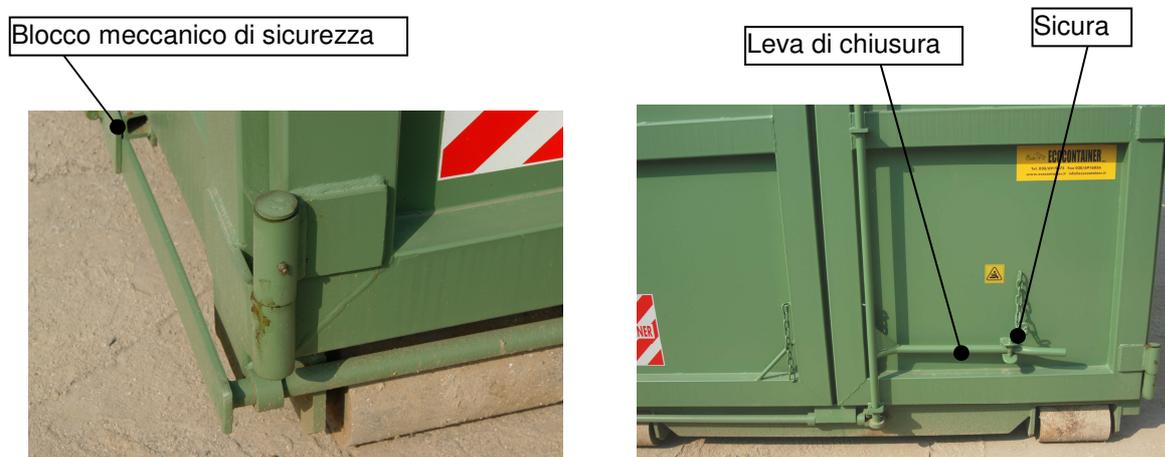
Nel caso non siano presenti le porte posteriori per svuotare il CONTAINER bisogna adagiarlo al suolo ed aprire il coperchio, collocando l'asta di sicurezza con il proprio blocco meccanico (lucchetto). Con l'ausilio poi di un braccio meccanizzato dotato di idonee pinze, prelevare il materiale contenuto all'interno. Al termine dello svuotamento richiudere il coperchio se il luogo ove viene riposto non è quello adibito al conferimento da parte dell'UTILIZZATORE.
